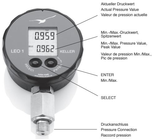
Digitales Manometer mit Spitzendruckwert-Erfassung und Min.-Max.-Anzeige.
